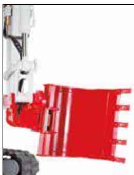
Powerilt con enganche rápido hidráulico, cazo montado al revés
